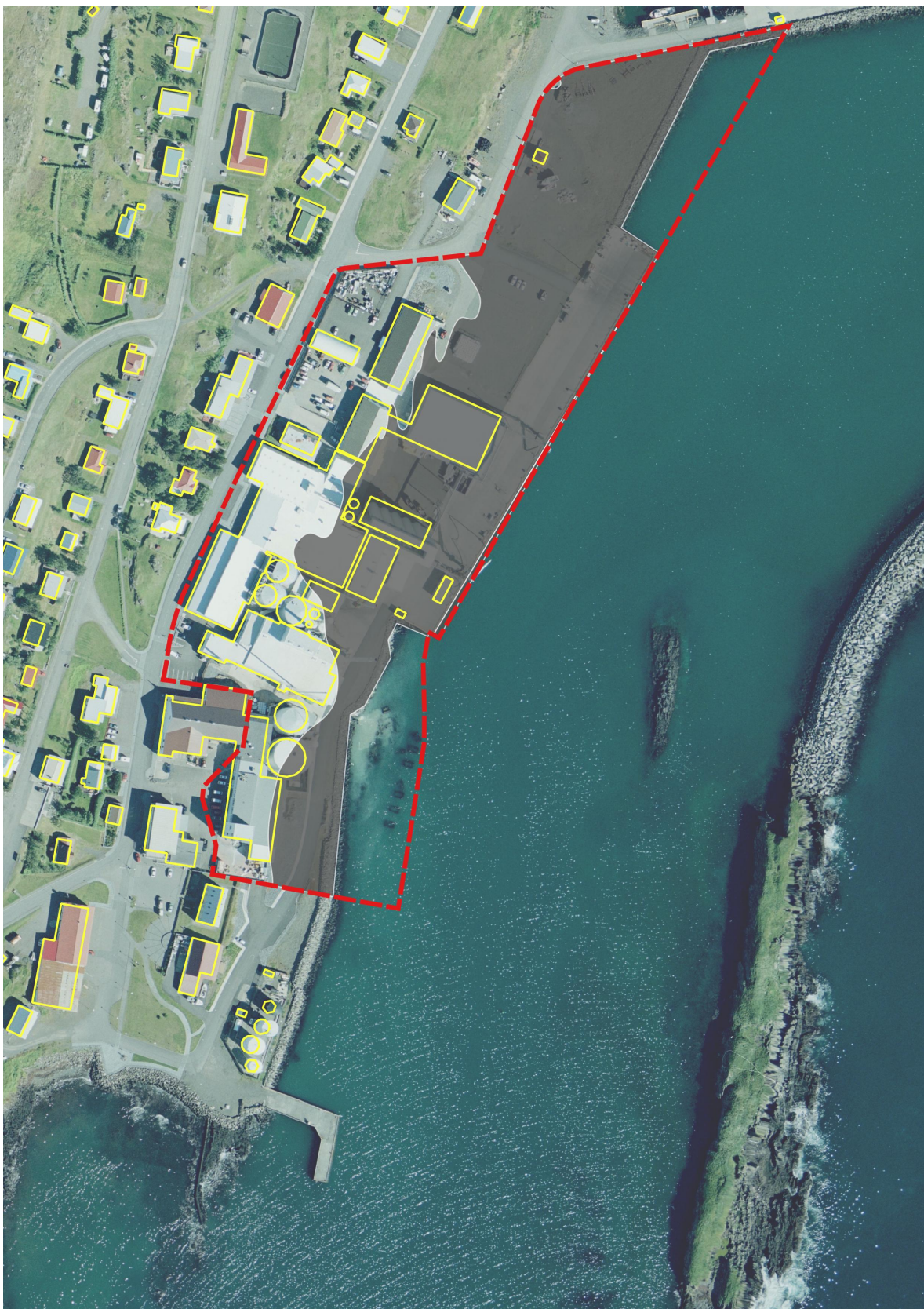
Mynd 2.6 Loftmynd sem sýnir áætlaðar landfyllingar sé miðað við strandlínu á korti frá 1947.
